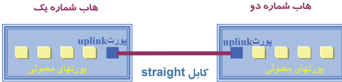
شکل ۱۸-۵ اتصال دو هاب با استفاده از پورت Uplink و یک کابل Straight
